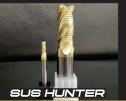
刃径公差12≥0~-0.02 / 12<0~-0.03 シャンク公差h6 /// SUSや耐熱合金に対してのポケットや溝加工へのアプローチとして3枚刃 ラフィングをラインナップ(もちろん鉄にも使用可能です)。通常3枚刃の場合4枚刃に比べて送りスピードを上げにくいですが、ラフィング形分 にすることにより加工抵抗を抑え送りスピードを上げ易くする事と、切粉の排出をよりスムーズにするコンセプトのもとに開発いたしました。 熱合金に相性の良いCGコーティングを施しておりますのでSUS316、インコネルやハステロイなどの難削材の加工に非常に良い効果を発揮 きます。
