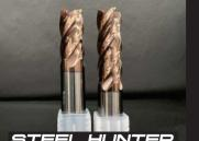
刃径公差 $12 \ge 0^{\circ}$ - $0.02 / 12 < 0^{\circ}$ -0.03 シャンク公差10 // 高硬度用のPOWERコーティングは母材との密着性も高く度3800Hv、耐熱性1000度、高リッチにアルミ成分を配合しているためコーティング表面に熱がかかることにより酸化アルミ
