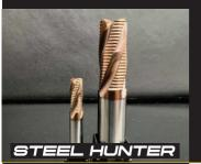
刃径公差12≧0~-0.02 / 12<0~-0.03 シャンク公差h6 /// TOTIMEの弱ねじれ防振型ラフィングエンドミルです。弱ねじれはZ軸方向 に負荷をかけたくない薄板の加工等に最適です。高硬度用のPOWERコーティングは母材との密着性も高く、コーティング硬度3800Hv、耐熱 性1000度、高リッチにアルミ成分を配合しているためコーティング表面に熱がかかることにより酸化アルミの形成膜ができ非常に硬くて耐摩 耗性に優れたコーティング膜を形成します。
