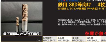
刃径公差12≥0°-0.02 / 12<0°-0.03 シャンク公差h6 /// TOTIMEの中ねじれ防振型ラフィングエンドミルです。高硬度用のPOWER コーティングは母材との密着性も高く、コーティング硬度3800Hv、耐熱性1000度、高リッチにアルミ成分を配合しているためコーティング表 面に熱がかかることにより酸化アルミの形成膜ができ非常に硬くて耐摩耗性に優れたコーティング膜を形成します。
