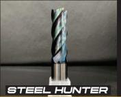
ア経公差12≥0^-0.02 / 12<0^-0.03 シャンク公差h6 /// 中ねじれ高硬度用エンドミル。母材は高級日本製母材0.2μmを使用、コーティング硬度は4500Hv、耐熱温度1200度で、非常にスペックが高いBlue nanoコーティングを採用しております。鋼であればこれー本で一般鋼から高硬度材までご使用頂けますが、芯厚が厚い分、径方向への切込量を深くかけますと目詰まりを起こす可能性も御座います。焼入れ後の仕上げ、もしくはトロコイド加工のような「径方向に薄く軸方向に深く」+「送りスピードを速く」に向いております。ステンレスへのご使用はお勧めいたしません。(本来のコーティングの性能を活かすのであればエアードライ推奨です)
