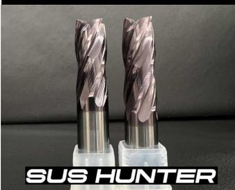
刃径公差  $12 \geq 0^{-0.02} / 12 < 0^{-0.03}$  シャンク公差 h6 // 耐熱性、高滑り性を兼ねそろえたアンバーコーティングはステンレスに相性が良いです。もちろん一般鋼に対しても問題はありません。弱ねじれの防振機能はZ軸方向に負荷を掛けたくない加工に最適なエンドミルです。
