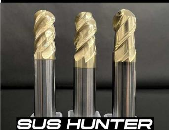
刃径公差12 $\geq$ 0 $\sim$ -0.02 / 12<0 $\sim$ -0.03 シャンク公差h6 /// 防振スクエアエンドミルの4346MTのボールバージョン。CGコーティングは硬度4200HV、耐熱温度1100°をマークしており多層コーティングで表面に滑り性をもたせステンレス、鋼全般に使用できます。より切れ味を持たせハイスパックコーティングにより刃先欠損を担保しながら高い加工条件でより安定性を持たせ、長寿命に使用できるコンセプトで開発されたボールエンドミルです。ステンレスには抜群の威力を発揮いたします。
