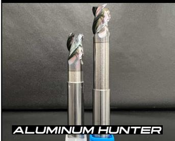
刃径公差12≥0<sup>-</sup>-0.02 / 12<0<sup>-</sup>-0.03 シャンク公差h6 /// 水素フリーDLCコーティング付3枚刃ネック付アルミ用エンドミルです。日本メーカー製良品母材を使用した品質にこだわった製品です。水素フリーDLCは通常のDLCよりコーティング膜が薄く刃のシャープ度を保持したまま、滑り性は抜群でコーティングの表面硬度は通常のDLCコーティングの約2倍を誇ります(HDC約5000Hv DLC約2000Hv)。故にアルミのドライ加工を実現できます。ハイクラスのエンドミルでありながら安価に抑えております。切削有効長3Dと5Dをシリーズ内に取り揃えております。
