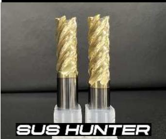
刃径公差12≧0<sup>-</sup>-0.02 / 12<0<sup>-</sup>-0.03 シャンク公差h6 /// SUSや耐熱合金に対しての側面高速加工のアプローチとして5枚刃をラインナップ。耐熱合金に相性の良いCGコーティングを施しておりますのでSUS316、インコネルや Hastelloy などの難削材の加工に非常に良い効果を発揮できます。
