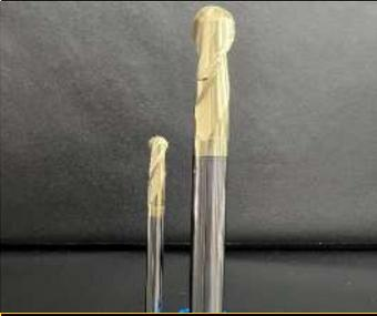
刃径公差12 $\geq$ 0 $\sim$ -0.02 / 12<0 $\sim$ -0.03 シャンク公差h6 /// コーティングはCGコーティングに極めて近いコーティングを採用しております。鉄はもちろんSUSや耐熱合金に対応できます。刃径よりシャンクが細いため深い溝や底面を加工するのに非常に便利な工具となります。
