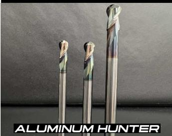
刃径公差12 $\geq$ 0 $^{-}$ -0.02 / 12<0 $^{-}$ -0.03 シャンク公差h6 /// コーティングは水素フリーDLCコーティング(HDC2)を採用しております。アルミ、非鉄用です。刃径よりシャンクが細いため深い溝や底面を加工するのに非常に便利な工具となります。
