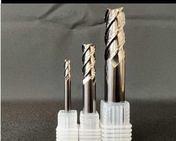
刃径公差 $12 \geq 0^{-0.02} / 12 < 0^{-0.03}$  シャンク公差h6 /// サーメットを母材としたエンドミルです。鉄の最終仕上げに使用すると驚くほど表面が美しく仕上がります。
