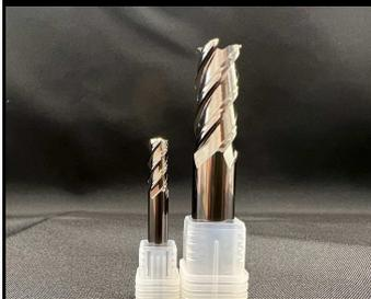
刃径公差12≥0<sup>-</sup>-0.02 / 12<0<sup>-</sup>-0.03 シャンク公差h6 /// サーメットを母材としたコーナ-Rエンドミルです。鉄の最終仕上げに使用すると驚くほど表面が美しく仕上がります。
